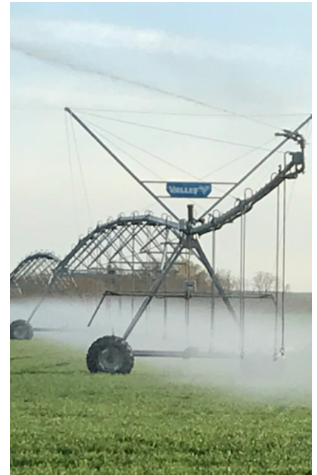
Beregnung als ein wertvoller Schlüssel zur Ertragsstabilisierung – Niederdruckregner in Bodennähe sichern den effizienten Wassereinsatz und simulieren am Besten Naturregen.
